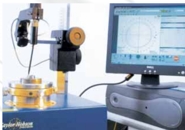
Macchina controllo rotondità Roundness testing
