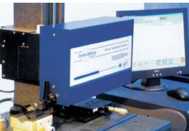
Macchina controllo rugosità superficie Roughness testing
